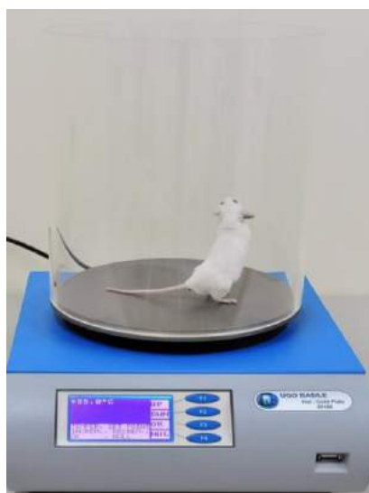
Ảnh 3.11. Chuột nhắt trắng trong thử nghiệm tác dụng giảm đau của DDHV theo phương pháp “mâm nóng” (Hotplate). Chuột được đặt lên máy đo đau bản nóng-lạnh, nhiệt độ bề mặt đặt chuột được tự động duy trì ở nhiệt độ 56^{\circ}\text{C} (\pm 1^{\circ}\text{C}) .
